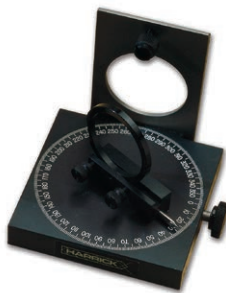
Brewster 角支架测量固体样品在不同入射角下光的透射率。
