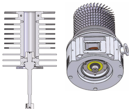
3 つのバランス面で独自のバランス技術を実現するローター
