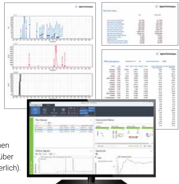
Beispiel eines von einem Agilent 8890 GC mit FID und TCD mithilfe von OpenLab CDS erstellten Berichts über Leichtgase und Kohlenwasserstoffe.
