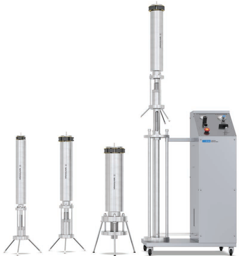
여러 컬럼을 하나의 모바일 스테이션에 결합하고 잠금 해제 기능을 사용하여 실험실 어디에서나 충전 컬럼을 배치할 수 있습니다.
