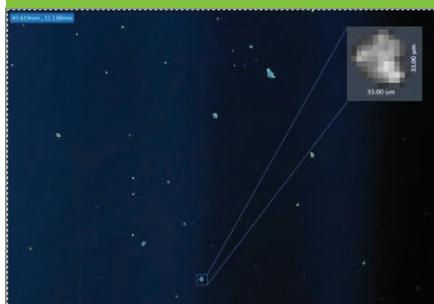
**第 4 步：**将每幅谱图与谱库进行比较，鉴定颗粒的化学组成。LDIR 具有高放大倍率可见光摄像头，可对颗粒进行拍摄。本例中，在污水中鉴定出了聚苯乙烯微塑料颗粒。
