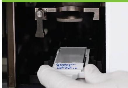
**第 3 步：**仪器将使用单波数光进行区域扫描，以确定所有颗粒的位置。在 5  $\mu\text{m}$  像素分辨率下，4 分钟即可完成  $10 \times 10 \text{ mm}$  区域的扫描。然后，仪器以鉴定出的颗粒（以亮点显示）为目标，采集每个颗粒的红外光谱。
