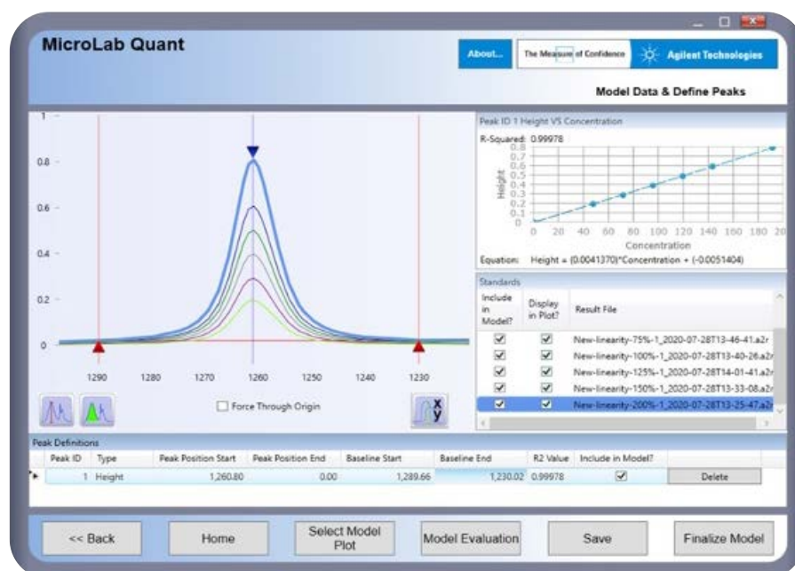
Figura 9. Evaluación de la linealidad del módulo de muestreo DialPath con MicroLab Quant. Los cálculos de la curva de calibración y del coeficiente de correlación se realizaron automáticamente en el software.
