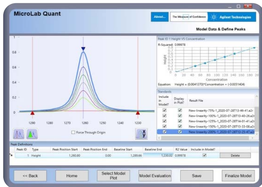
Abbildung 9. Lineare Evaluierung des DialPath-Probenzubehörmoduls unter Verwendung von MicroLab Quant. Die Erstellung der Kalibrierungskurve sowie die Berechnung des Korrelationskoeffizienten erfolgte automatisch mit der Software.
