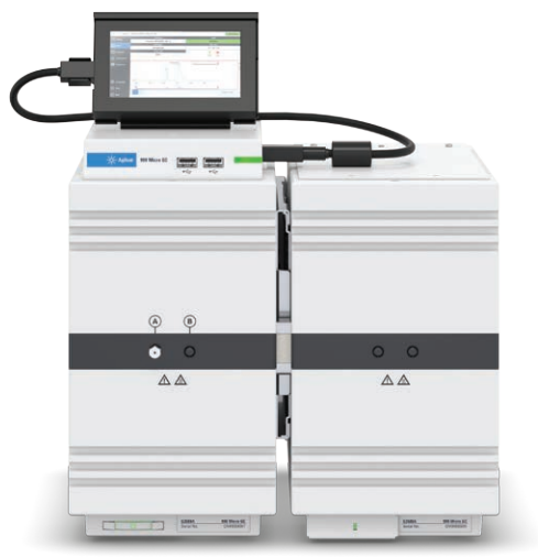
990 微型气相色谱具有通道扩展柜和可选触摸屏，可提供多达四个通道，以大幅提高分析效率
