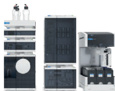
1290 Infinity II präparatives LC-System
