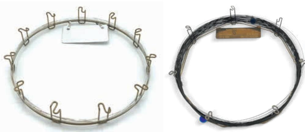
Confronto tra colonna Agilent (a destra) e colonna della concorrenza (a sinistra). Dopo 25 ore di utilizzo a 400 °C, la colonna per GC 5ht della concorrenza si è sgretolata, mostrando segni di depolimerizzazione. Il rivestimento della colonna per GC Agilent J&W DB-5ht è rimasto uniforme e la colonna ha mantenuto la propria flessibilità.
