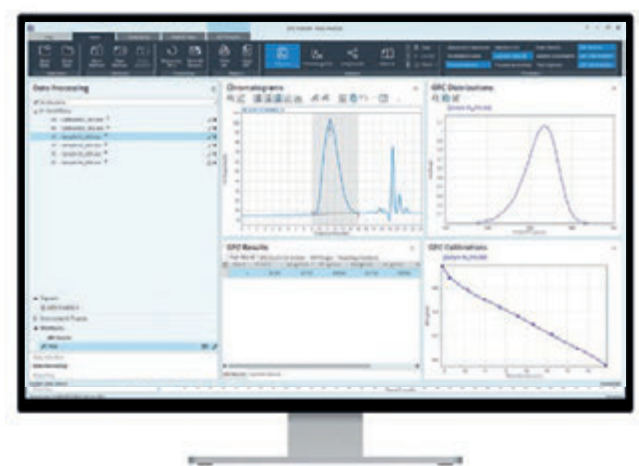
Captura de tela do software GPC/SEC para OpenLab CDS mostrando o cromatograma e a distribuição de peso molecular para uma amostra de poliestireno.
