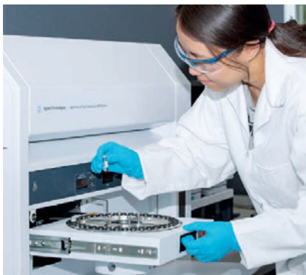
Sistema de GPC de alta temperatura (HT) 1260 Infinity II
