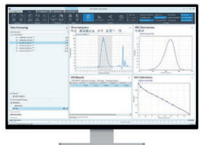
Screenshot der GPC/SEC-Software für OpenLab CDS, der das Chromatogramm und die Molekulargewichtsverteilung für eine Polystyrolprobe zeigt.
