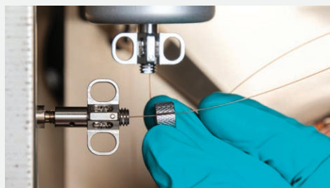
자체 조임 컬럼 너트 설치 - MS 인터페이스 동영상: www.agilent.com/en/video/stcn-mass-spec
