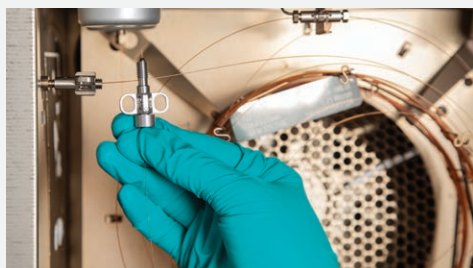
자체 조임 컬럼 너트 설치 - 주입구 및 검출기 동영상: www.agilent.com/en/video/stcn-inlet-detector
