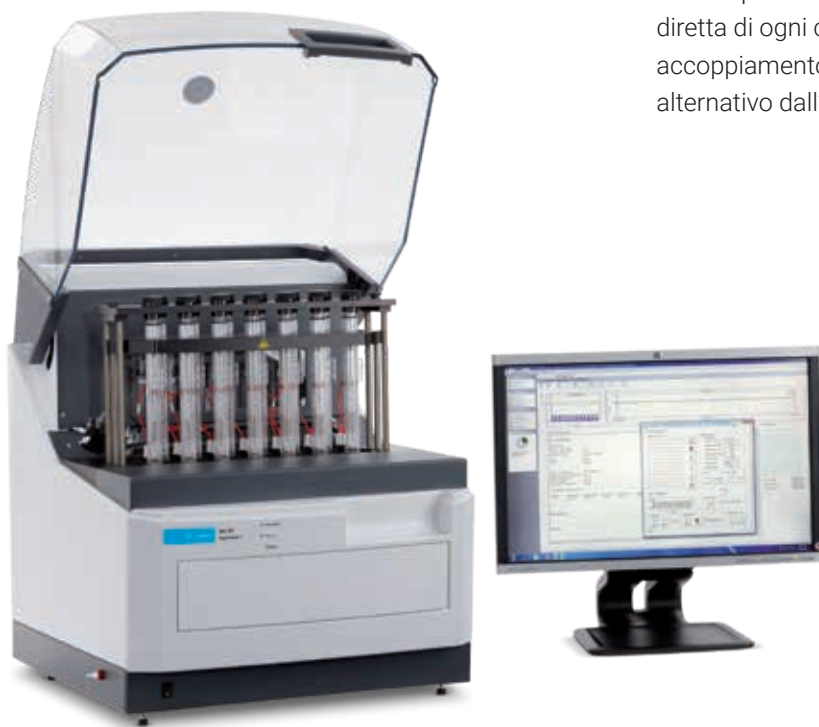
Il sistema Agilent 400-DS è uno strumento innovativo ad alte prestazioni per eseguire test di bassi livelli dei tassi di rilascio di principi attivi farmaceutici da presidi medici.
