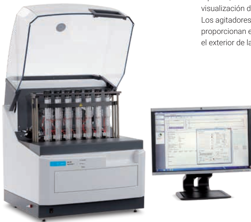
El 400-DS de Agilent es un instrumento innovador y de alto rendimiento que permite analizar las tasas de liberación de bajo nivel de API procedentes de los dispositivos médicos.
