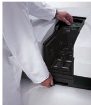
3. Puxe a barra para travar o acessório.
