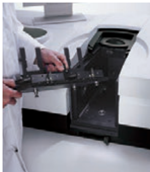
1. Insira o acessório no compartimento de amostra.
