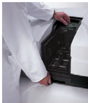
3. Actionnez le levier pour verrouiller l'accessoire.
