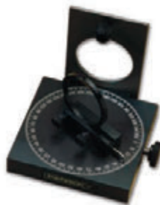
Der Brewster-Winkel-Halter misst die Transmission von Licht bei verschiedenen Einfallswinkeln auf einer festen Probe.
