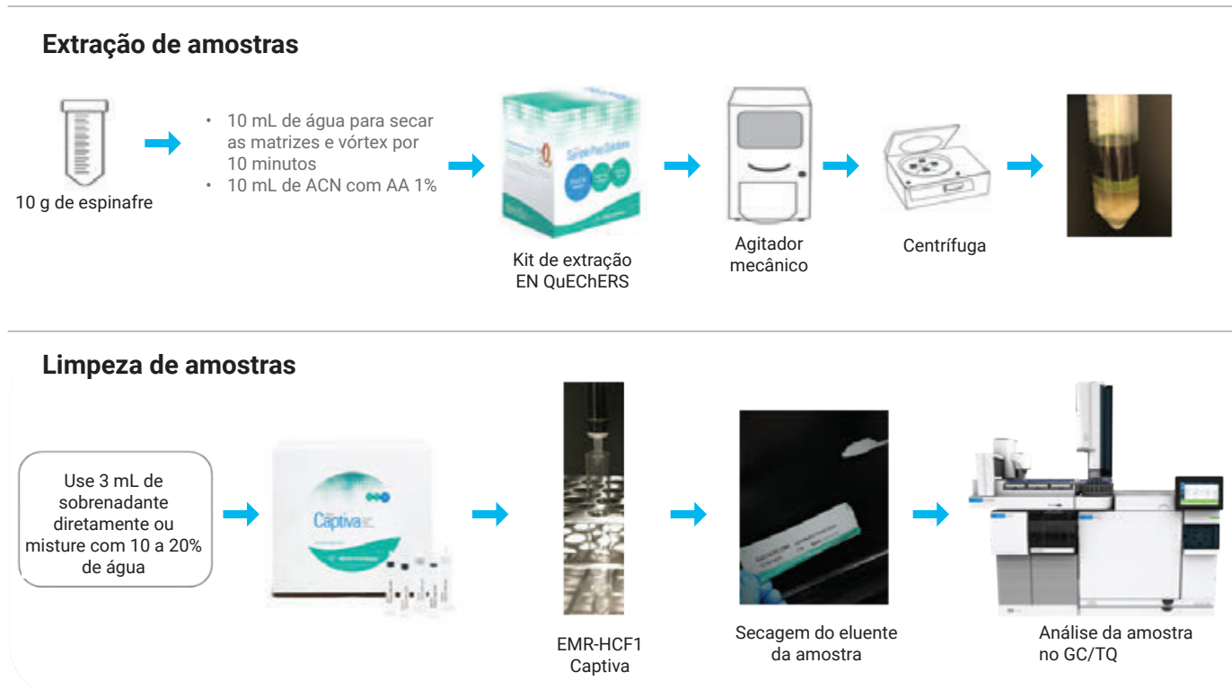
Figura 1. Fluxograma de preparo de amostras, incluindo extração AOAC Agilent tradicional, seguida de limpeza por permeabilidade EMR-HCF1 ou HCF2 Agilent Captiva. 1
