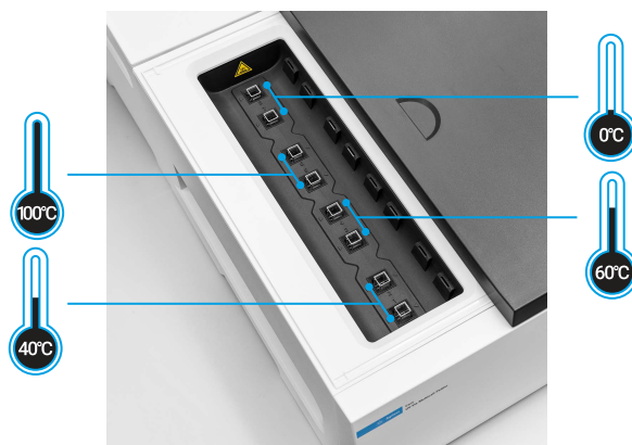
图 6. 使用多区控温软件附件进行温度控制
