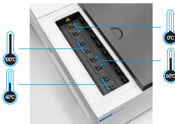
Figura 6. Control de temperatura mediante el complemento Multizone
