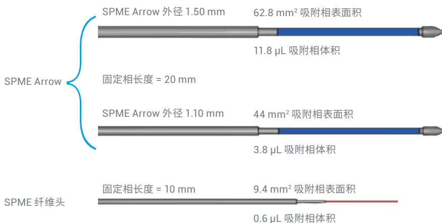
图 1. SPME Arrows 和 SPME 纤维头的吸附相表面积和吸附相体积比较
