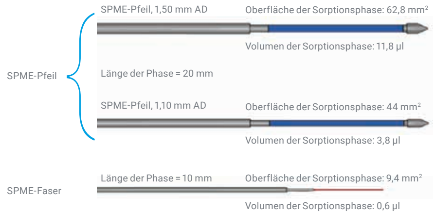
Abbildung 1: Vergleich der Oberflächen und Volumina der Sorptionsphase für SPME-Pfeile und SPME-Fasern.
