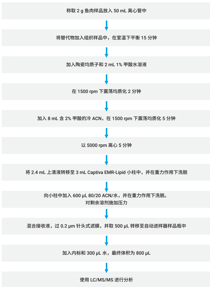
图 1. 样品前处理工作流程示意图 [4]
