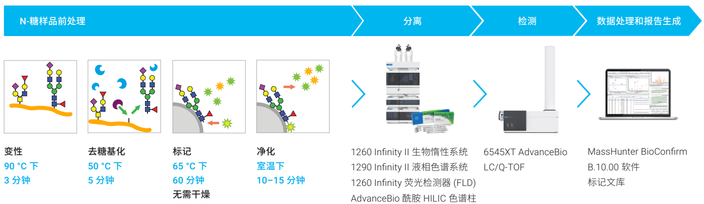
图 1. 使用 Gly-X 2-AB Express 样品前处理与 LC/FLD/MS 的游离 N-糖分析工作流程
