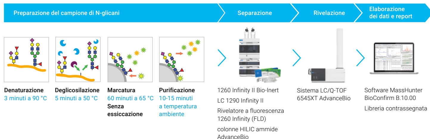
Figura 1. Flusso di lavoro di analisi degli n-glicani rilasciati utilizzando la preparazione del campione Gly-X 2-AB Express con LC/FLD/MS.
