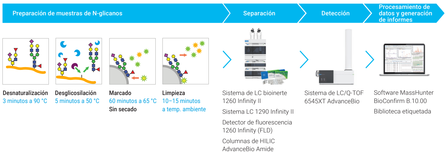
Figura 1. Flujo de trabajo de análisis por LC/FLD/MS de N-glicanos liberados mediante el uso de la preparación de muestras con el kit Gly-X 2-AB Express.
