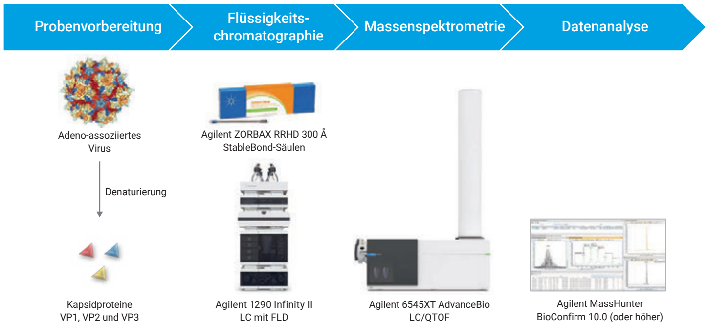
Abbildung 1. Überblick über das Verfahren zur Bestätigung der Identität und zur Messung der relativen Mengen der einzelnen Kapsidproteine, die das intakte AAV-Kapsid bilden.
