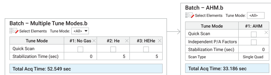
图 3. Agilent 7900 与 9500 系列 ICP-MS 饮用水分析方法对比。借助单一模式的简便性，AHM 模式可节省 37% 的采集时间，从 53 s 缩短至 33 s
