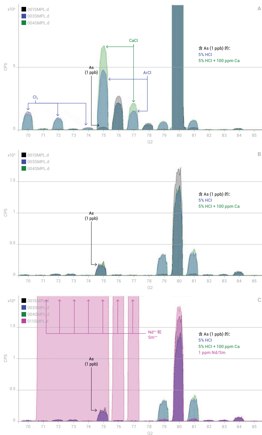
图 1. a) 无气体模式下, \text{ArCl}^+ 和 \text{CaCl}^+ 在 m/z 75 处对 \text{As}^+ 的多原子干扰; b) He 碰撞模式下消除了 \text{ArCl}^+ 和 \text{CaCl}^+ 多原子干扰; c) He 碰撞模式无法消除 \text{Nd}^{++} 和 \text{Sm}^{++} 在 m/z 75 处的干扰
