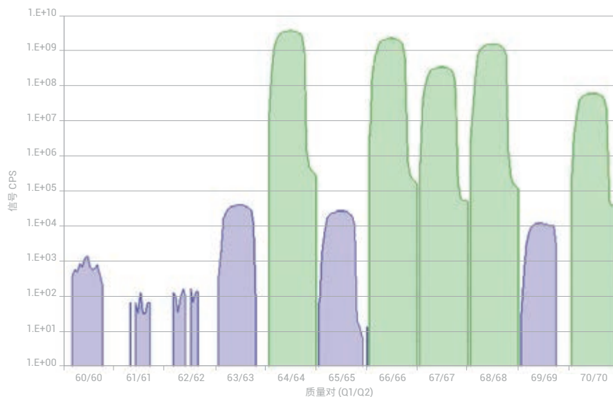
图 3. 加标 1 \mu\text{g}/\text{L} Cu 的 1000 mg/L Zn。(1 ppb: 63/所有同位素 = 0.667, 65/所有同位素 = 0.333, 没有进行质量歧视校正。如果 Zn 对 Cu 有影响, 那么它对 m/z 63 和对 m/z 65 的影响是不同的, 因为 Zn 同位素的丰度不同)
