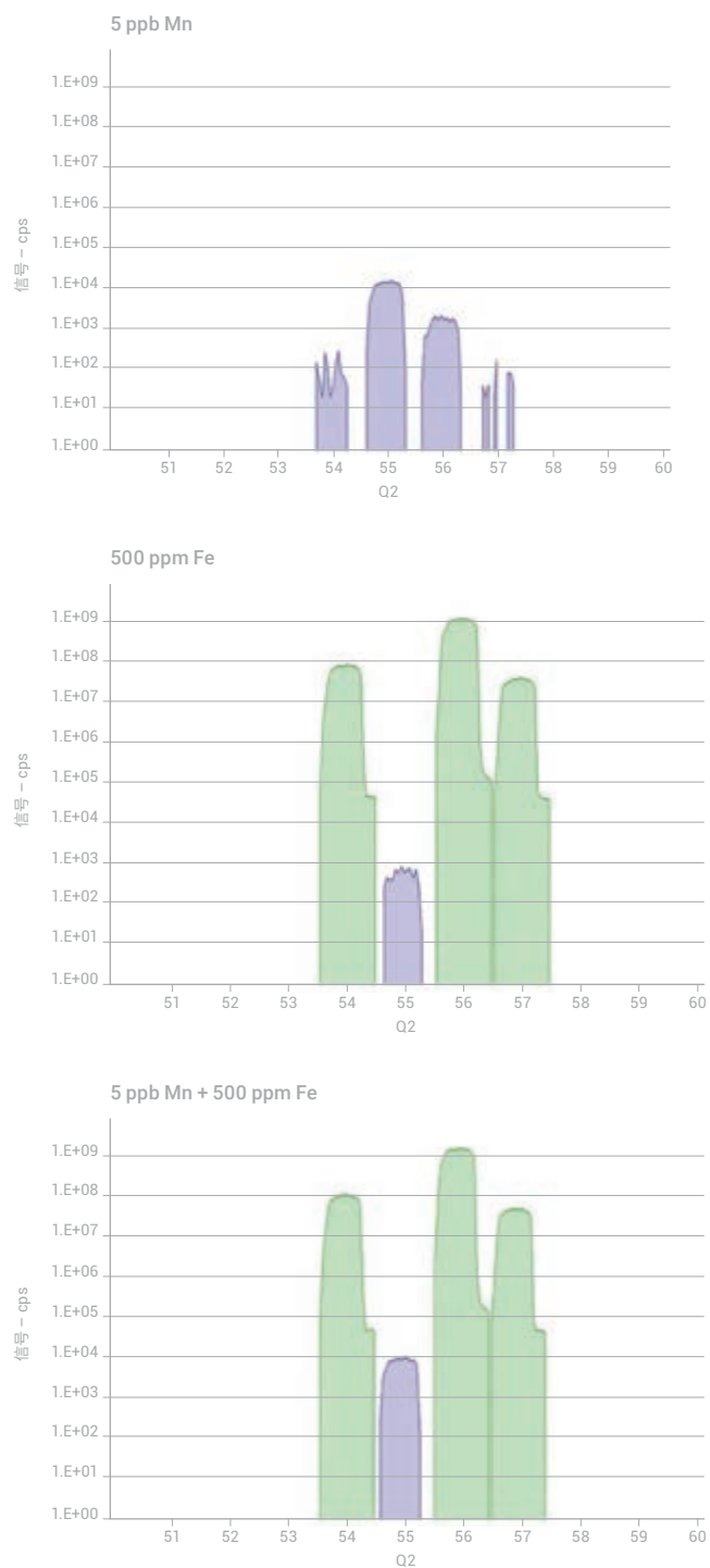
图 2. 氦气 MS/MS 模式谱图：(自上而下) 5 ppb Mn, 500 ppm Fe 和 5 ppb Mn + 500 ppm Fe
