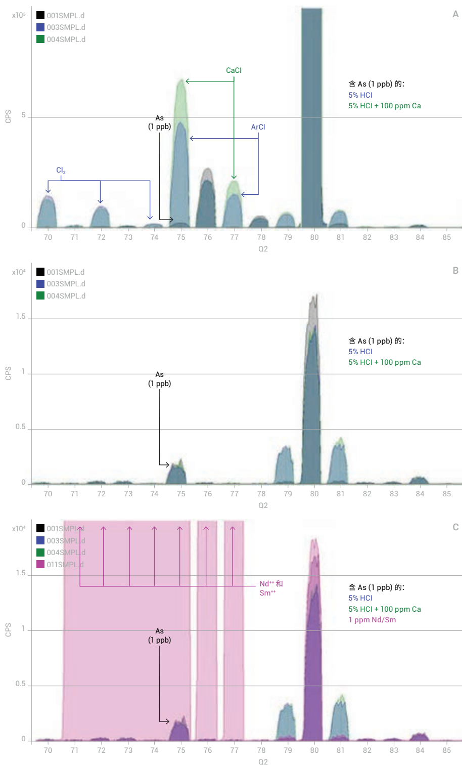
图 1. a) 无气体模式下， \text{ArCl}^+ 和 \text{CaCl}^+ 在 m/z 75 处对 \text{As}^+ 的多原子干扰；b) He 碰撞模式下消除了 \text{ArCl}^+ 和 \text{CaCl}^+ 多原子干扰；c) He 碰撞模式无法消除 \text{Nd}^{2+} 和 \text{Sm}^{2+} 在 m/z 75 处的干扰
