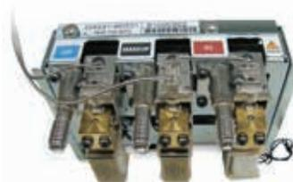
Модуль электронного регулятора давления (ЕРС) для системы GX Agilent 7820A.
