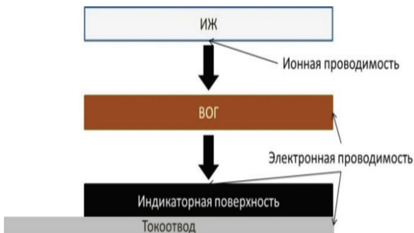
Рис. 2. Схема перехода от ионной к электронной проводимости в электроде в процессе измерений
