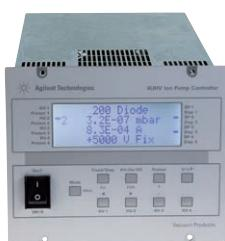
새로운 최첨단 Agilent 4UHV 이온 펌프 컨트롤러는 최대 4개의 VIP 200을 동시에 작동시킬 수 있으며, 개별(4x80W 구성) 또는 2 개의 VIP 200(2x200W)으로도 작동 가능합니다. 4UHV는 모든 종류의 이온 펌프(다이오드, 비활성 다이오드, StarCell)를 시작 및 제어할 수 있습니다. 가변 전압 기능은 작동되는 압력 범위에 걸쳐 최적의 펌핑 속도와 압력을 판독할 수 있도록 보장합니다.
