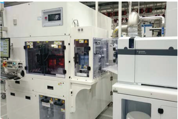
与 Agilent 8800 ICP-MS/MS 集成的由 IAS Inc. 制造的全自动 VPD-ICP-MS 系统 Expert PS。 图片由法国克罗勒的 ST Microelectronics 提供
