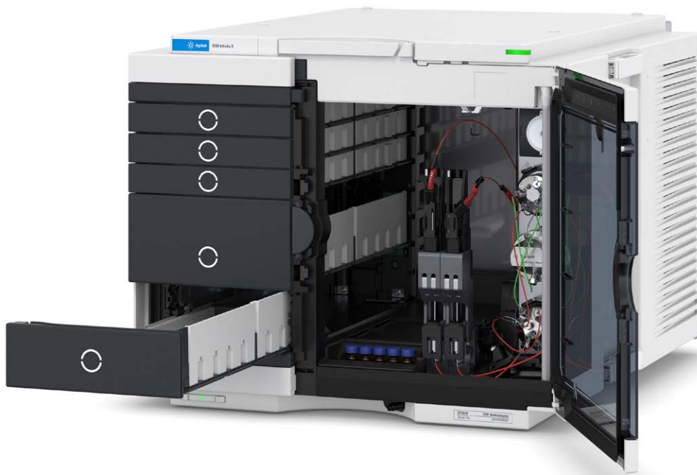
그림 15. 단일 서랍에 2mL 바이알과 96-well plate가 설치된 Agilent 1290 Infinity II Multisampler. 더 큰 시료 용기나 더 많은 시료를 수용하기 위해 더 크고 더 작은 서랍도 사용할 수 있습니다.
