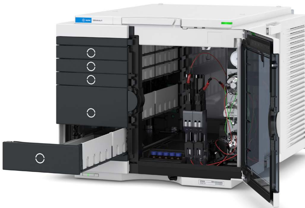
图 15. Agilent 1290 Infinity II Multisampler 在单个抽屉中可同时容纳 2 mL 样品瓶和 96 孔板。还提供更高和更矮的抽屉以容纳更大的样品容器或更多的样品
