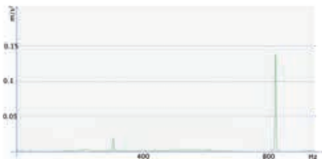
Анализ вибраций с помощью быстрого преобразования Фурье: для TwisTorr 404 FS, 704 FS и 804 FS*
