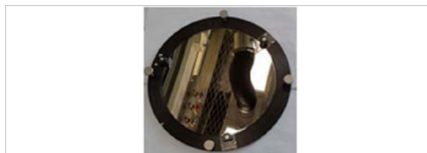
图 3. 直径 200 mm 的预切割的晶片安装于附接到固体自动进样器中的 8 英寸样品支架中
