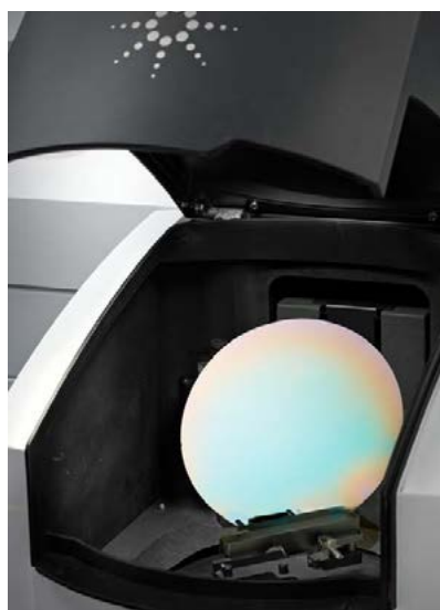
图 1. Agilent Cary 7000 UMS，测量室中安装了一个直径为 200 mm 的硅片
