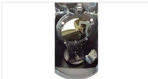
图 4. Cary 7000 UMS 样品室的前视图，样品室中安装了安捷伦固体自动进样器，自动进样器中安放了直径为 200 mm 的涂层晶片
