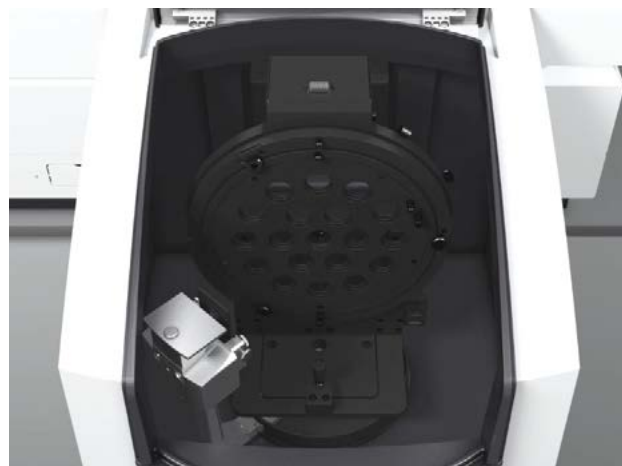
图 1a. 安装有固体进样器的 Cary 7000 UMS 测量室俯视图
