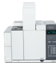
GC Agilent 7890B con horno de válvulas grande
