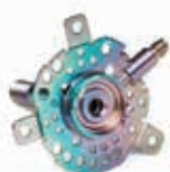
2 Percorso del flusso inerte: iniettore split/splitless
