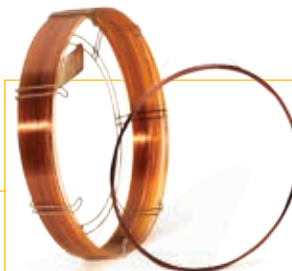
8 Colonne de GC Agilent J&W Ultra Inert et tube Ultimate Plus en silice fondue désactivée
