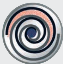
Le gaz pénètre dans l'ensemble de la spirale
