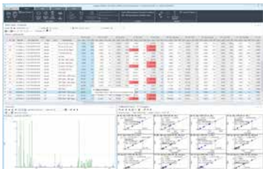
Painel de análise de dados do ICP-MS MassHunter, mostrando a tabela interativa de lotes, sinalizadores de outliers, o espectro da amostra atual e o resumo da calibração.
