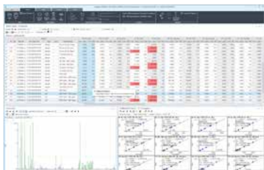
Panel de análisis de datos de ICP-MS MassHunter, mostrando la tabla de lotes interactiva, los indicadores de valores atípicos, el espectro de la muestra actual y el resumen de la calibración.
