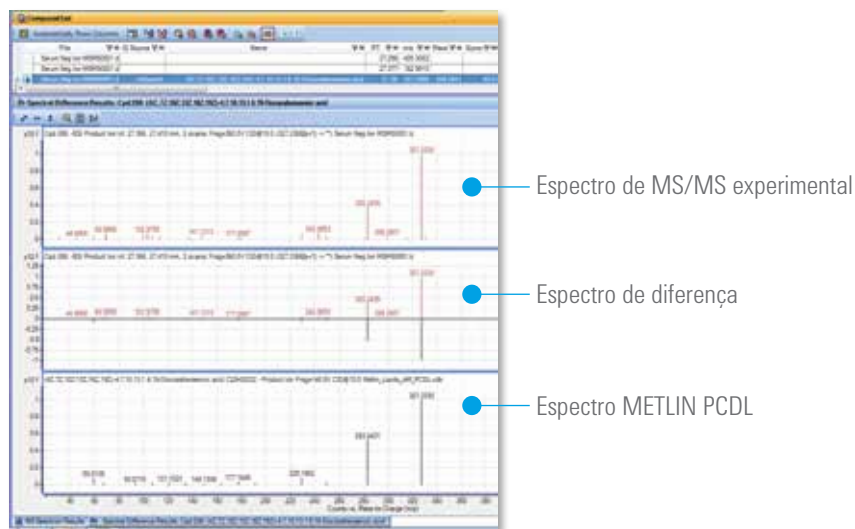
Figura 9. Resultados de pesquisa na biblioteca de MS/MS de uma amostra de soro humano no software de análise qualitativa MassHunter em relação ao PCDL de metabólito METLIN. O espectro superior é o MS/MS coletado em um Q-TOF Agilent para um dos compostos; o inferior é o espectro da biblioteca do METLIN. O intermediário mostra o espectro da diferença. A pontuação na Lista de compostos (92.6) indica um resultado de alta qualidade.
