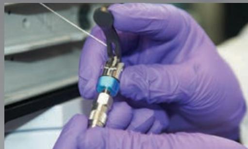
레버를 누르듯 간편한 연결: 애질런트의 독보적인 설계인 스프링 장착 메커니즘으로 무효 부피(dead volume) 없이 확실하고 단단한 연결을 제공합니다.
