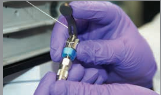
Einfach durch Betätigen eines Hebels: Das patentierte Agilent-eigene Design hat einen Federmechanismus, der für null Totvolumen und eine sichere und feste Verbindung sorgt.
