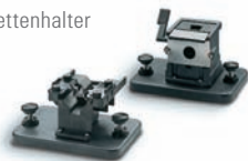
Peltier-gekühlter thermostatisierbarer Küvettenhalter
