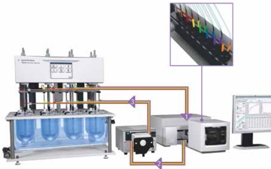
Sistema di dissoluzione UV online ad apparato singolo Cary 8454 con 708-DS e sistema di trasporto multicella.
